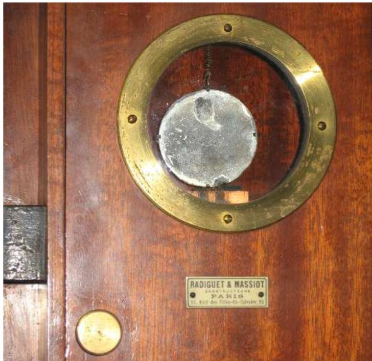
Particolare del Ricevitore Telegrafico a riflessione Radiguett e Massiot - Constructeurs - Paris.
