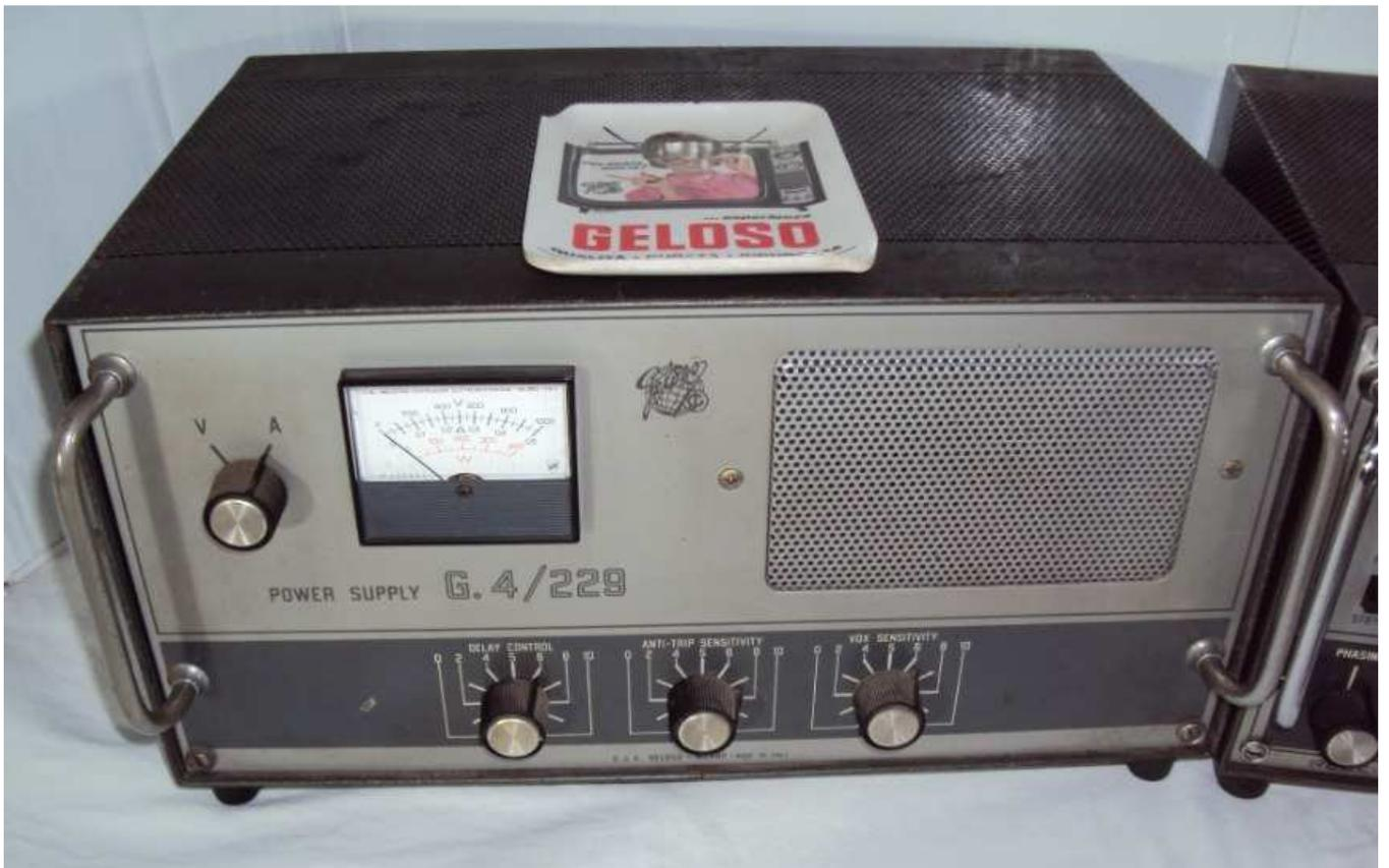
Alimentatore G4/229 dotato di altoparlante
