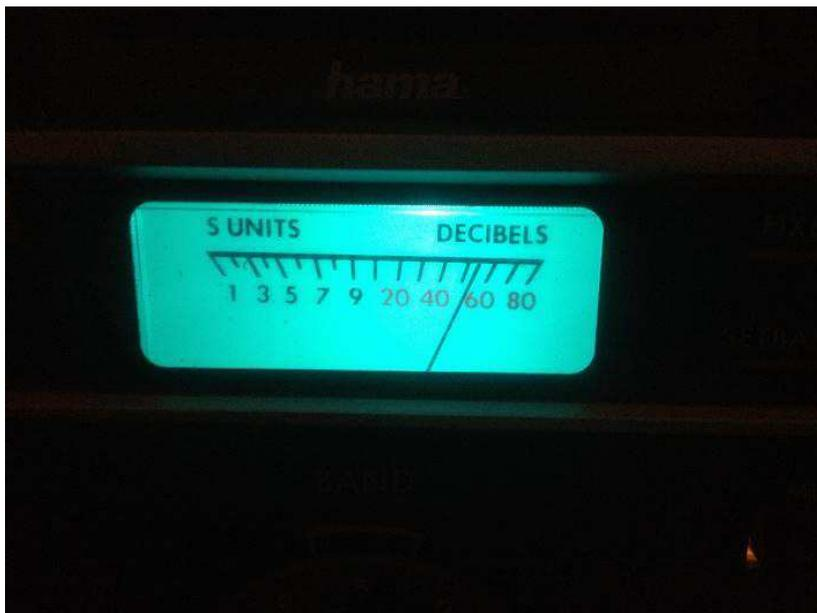
Regolando il guadagno dell'antenna principale (dipolo) e della secondaria (loop Wellbrook) per avere due segnali di pari intensità si nota un punto in cui il segnale tende a diminuire.
